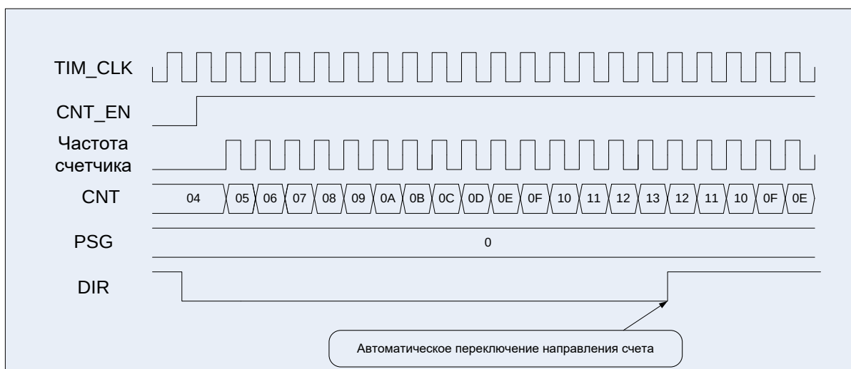
Рисунок 48 – Диаграммы работы таймера, счет двунаправленный, сначала прямой
