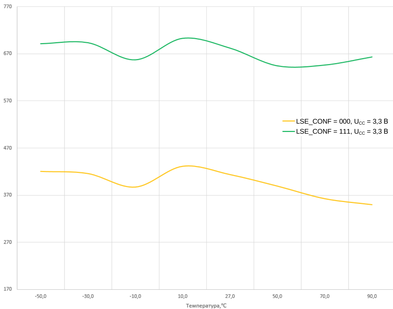
Рисунок 151 – Зависимость тока потребления генератора LSE по питанию U_{CCB} микросхем MDR1206AFI (CHIP_ID = 215) от температуры при U_{CC} = U_{CCA} = U_{CCB} = 3,3 В
